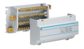
Brass busbar terminal 160A, 4pole, 1x 10-50<sup>2</sup> / 3x 10-35<sup>2</sup> / 8x 2,5-16<sup>2</sup> per pole
